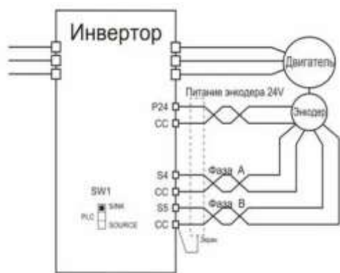
Сурет.1 Кодерді жиілік түрлендіргішіне қосу схемасы
