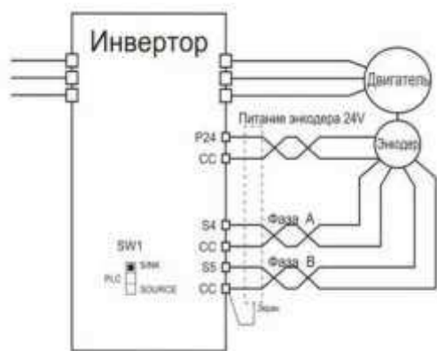
Сурет.1 Кодерді жиілік түрлендіргішіне қосу схемасы
